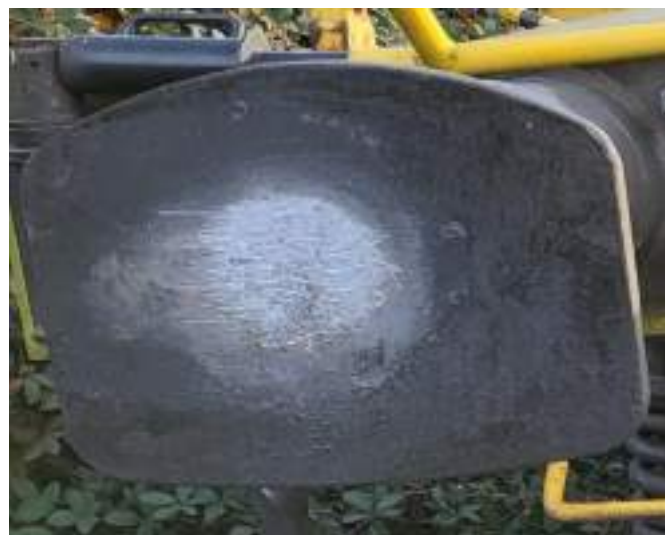
Figura nr.9 - Urme pronunțate de lucru pe talerele tampoanelor din spate al celui de-al 5-lea vagon
