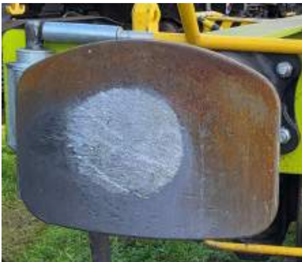
Figura nr.4 - Urme pronunțate de lucru pe talerele tampoanelor din față al celui de-al 6-lea vagon
