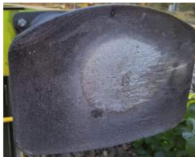
Figura nr.9 - Urme pronunțate de lucru pe talerele tampoanelor din spate al celui de-al 5-lea vagon
