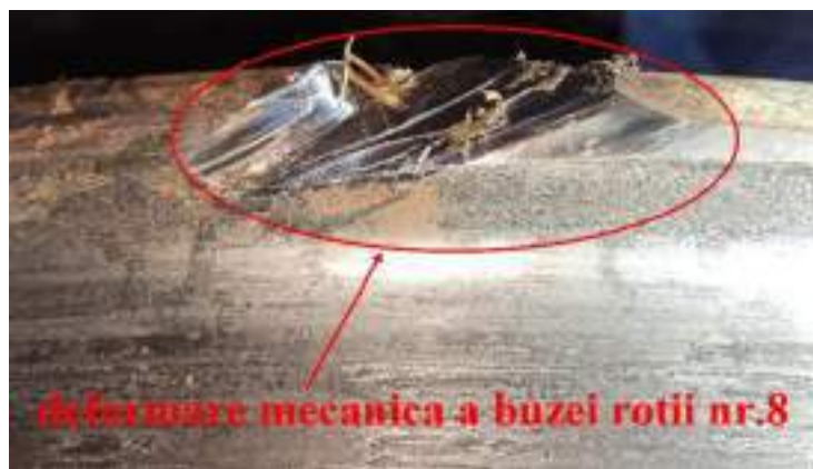
Foto nr.2 Buza roții nr.8 deteriorată
