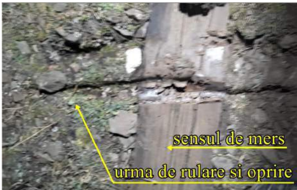
Foto. nr.32 – urma de rulare și oprire în dreptul vârfului inimii simple a schimbătorului nr.21b
