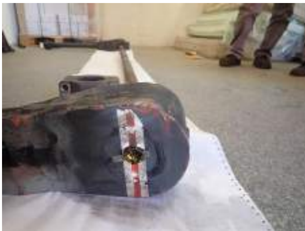
Foto nr. 1 - Marcajele de control de pe brațul ansamblului antiruli
