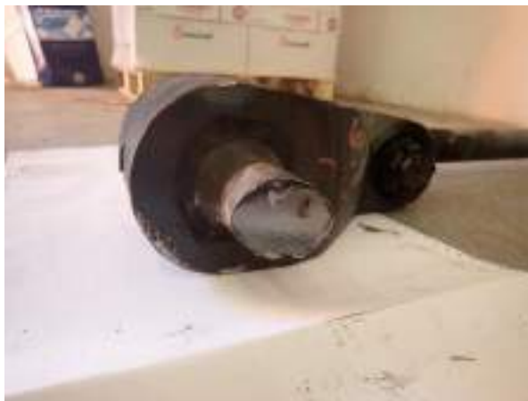
Foto nr. 2 – Suprafața de rupere a barei de torsiune
