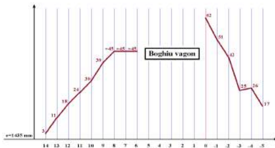
Diagrama nr. 1 - Diagrama de ecartament măsurat sub sarcina statică a materialului rulant
