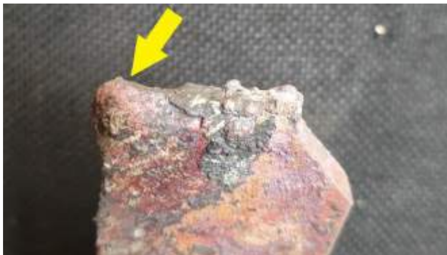
Imaginea nr.4 - topitura de cupru provocată de arc electric, la capătul barei de legătură
