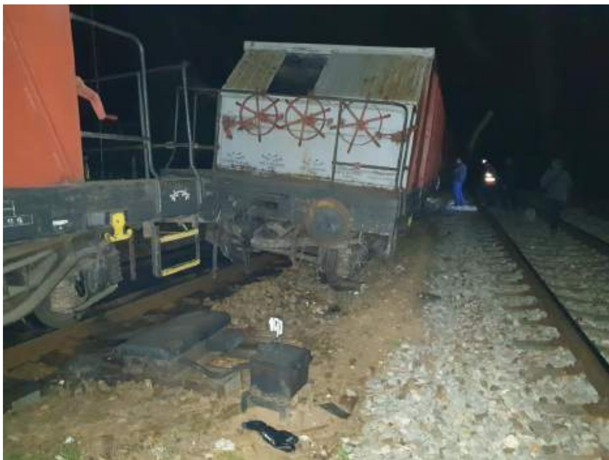
Foto nr.2: vagonul nr.82536993757-8 în stare deraiată (fotografiat din față partea stânga sens de mers)
