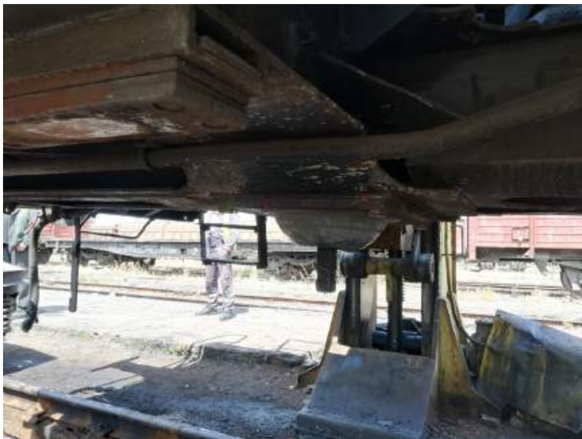
Foto nr.5: vagonul nr. 82536993757-8, crapodina superioară boghiul cu roțile nr.5-8
