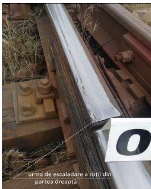
Foto nr.9 – urma de escaladare a roții din dreapta la joanta de capăt pe abaterea schimbătorului de cale nr.8
