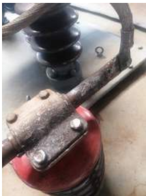
Foto nr. 1 - urme de arc electric de pe capătul barei de tensiune, legătura flexibilă, clema și șuruburile de strângere a barei de tensiune
