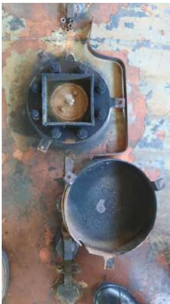
Foto nr.6 - urme de fum pe supapa DMA
