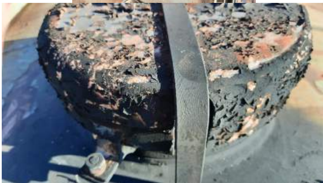
Foto nr. 4 - urme de afectare termică în zona supapei exterioare aferentă dispozitivului de punere la atmosferă (DMA)
