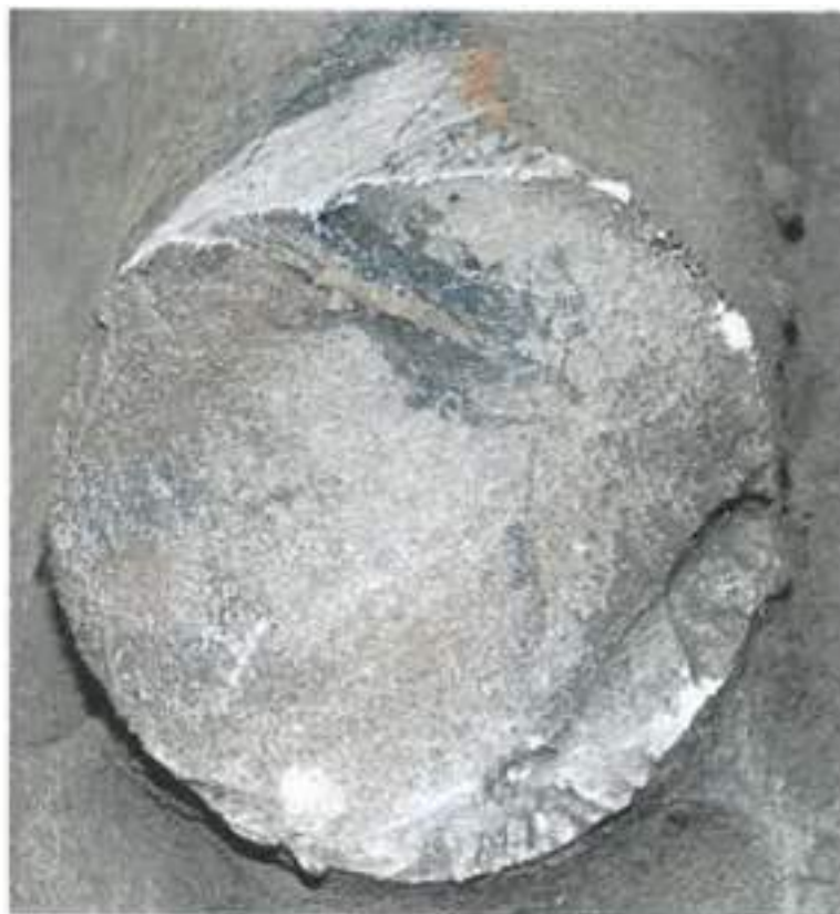
Foto nr. 9. -detaliu după ruperea bridei cilindrice
