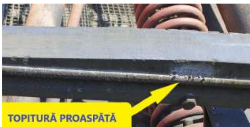
Imaginea 8 – granule de aluminiu topit proaspăt la sania patinei, cu urme de fum proaspete pe perie
