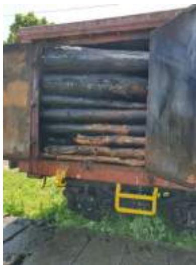
Imaginea 13 – în plan vertical, buștenii erau arși numai spre partea superioară a vagonului.
