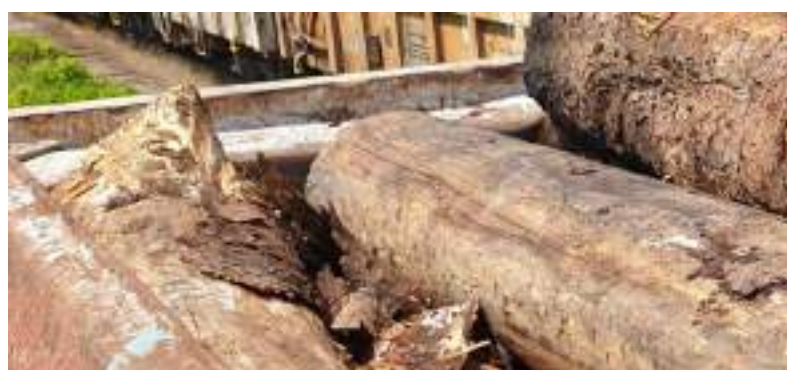
Imaginea 11 – buștenii erau mai puțin afectați de ardere în capătul vagonului, opus locomotivei.
