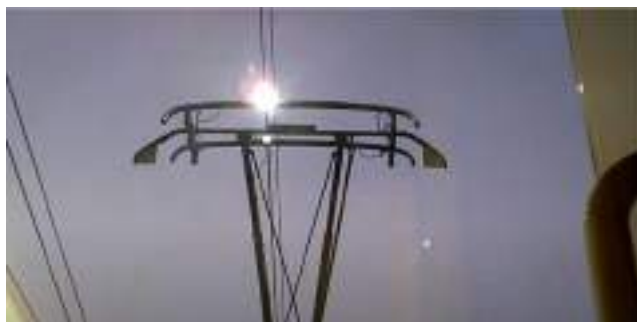
Imaginea 16 – exemplu de scânteiere electrică la pantograf
