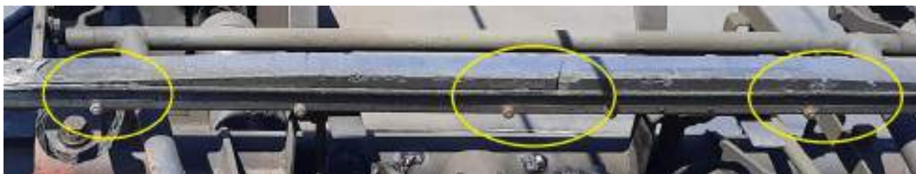
Imaginea 9 – în special în zona șuruburilor de strângere erau prezente topituri de aluminiu
