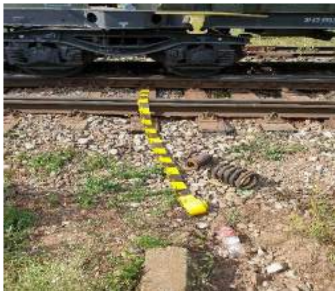
FOTO nr. 6, distanța de la linia de circulație până la setul de arcuri elicoidale de suspensie, sărite de la al doilea boghiu al primului vagon deraiat.
