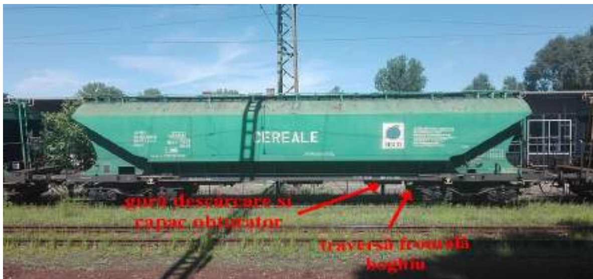
Foto nr.9, poziționare gură de descărcare, capac obturator și traversă frontală boghiu
