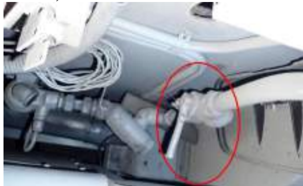
Foto nr.4 - robinetii de izolare pneumatică a instalațiilor DSV și INDUSI de la locomotiva EA 194
