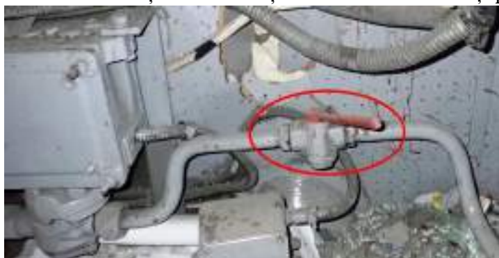
Foto nr.4 - robinetii de izolare pneumatică a instalațiilor DSV și INDUSI de la locomotiva EA 194
