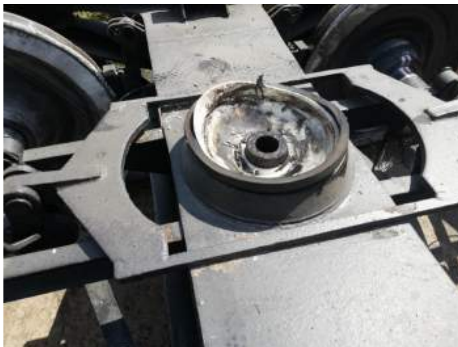
Fotografia nr.7 - Crapodina inferioară a boghiului deraiat
