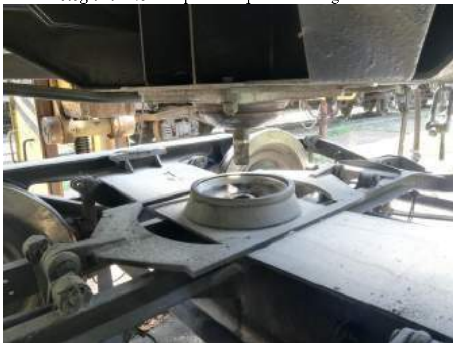
Fotografia nr.9 - Crapodina inferioară și superioară a boghiului nederaiat
