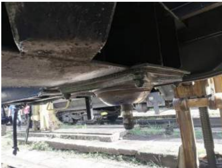
Fotografia nr.8 - Crapodina superioară a boghiului deraiat
