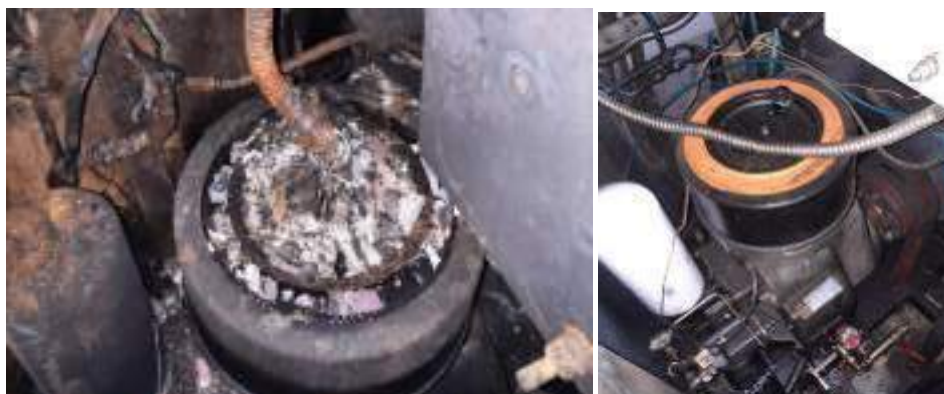
Foto nr. 5 și 6 - filtru de aer al compresorului afectat termic în comparație cu un filtru neafectat
