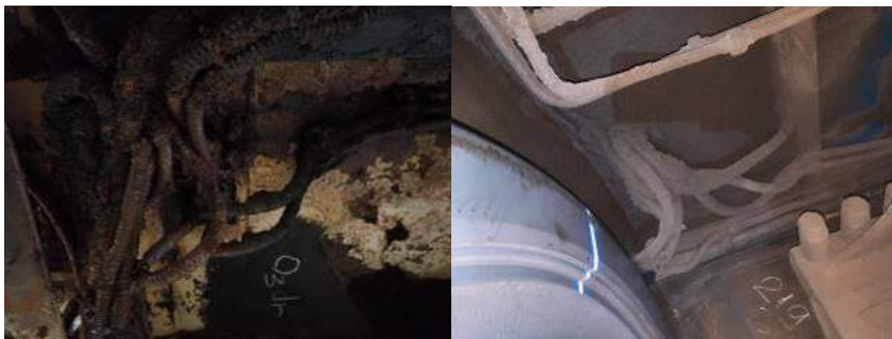
Foto 12 și 13 - locul de traversare a cablurilor electrice, la locomotiva EA 251, în comparație cu o locomotivă din exploatare
