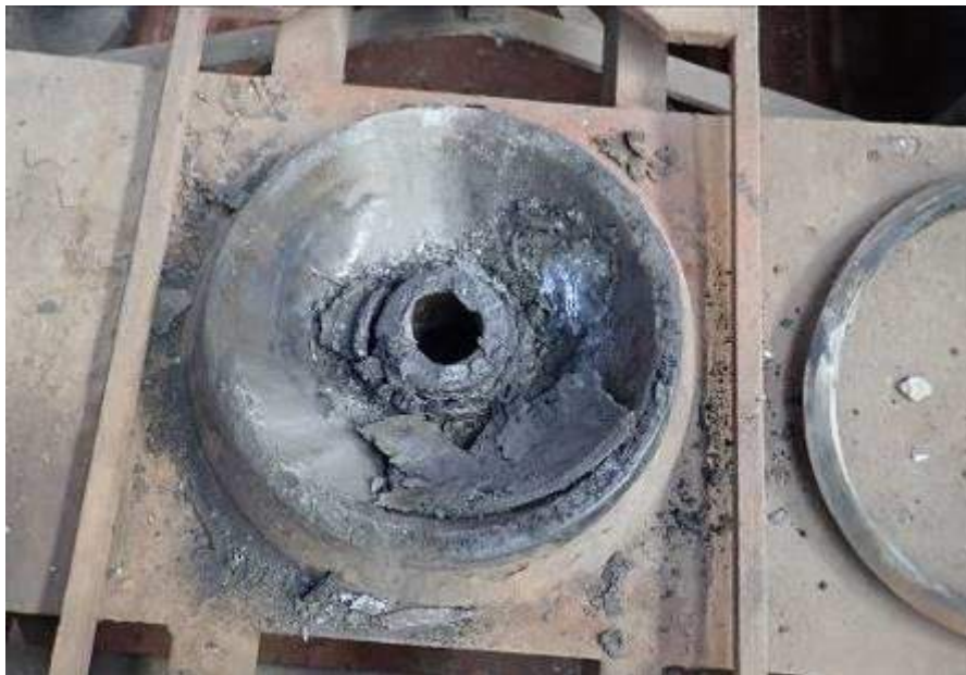
Foto nr.1 - Crapodina inferioară de la boghiul deraiat cu placa de poliamidă distrusă și garnitura de etanșare
