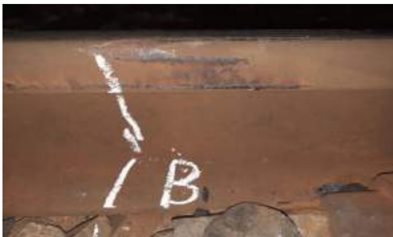
Foto nr.4: Urma părăsirii flancul inactiv al șinei, punctul "B".
