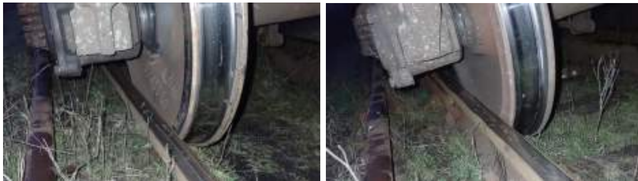
Foto nr.3 - vagonul nr.61517355- după deraiere
