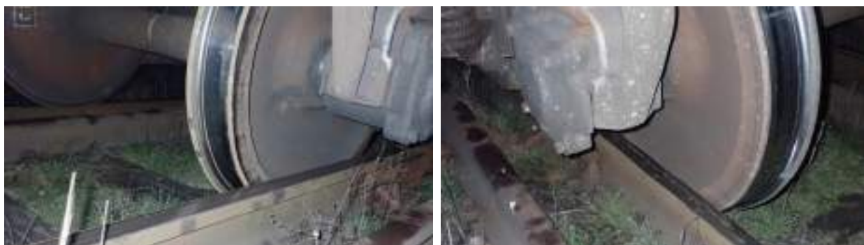
Foto nr.4 - vagonul nr.67846618 - după deraiere
