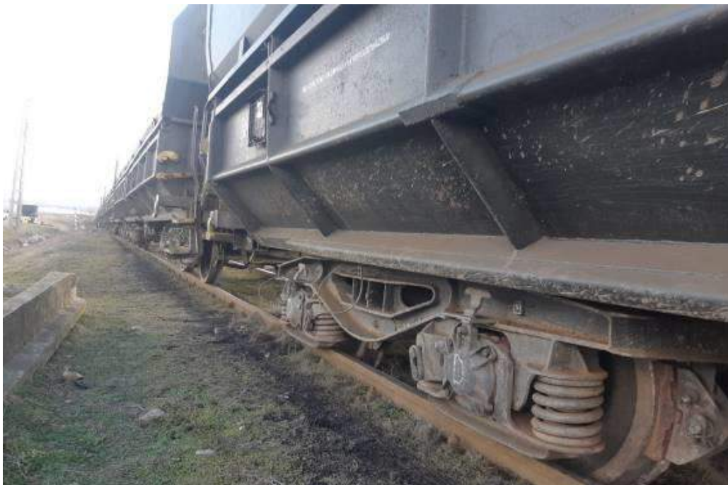
Foto nr.3 : vagonul al 10-lea de la siguranță, nr.81536652870-2, în stare deraiată
