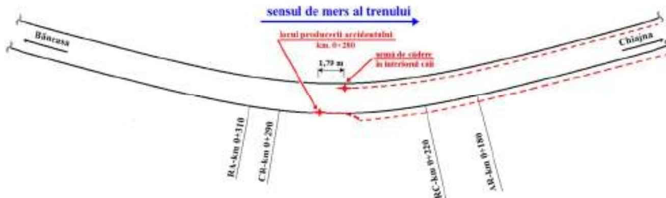
Figura nr.3 – Reprezentarea schematică a curbei pe care s-a produs accidentul feroviar
