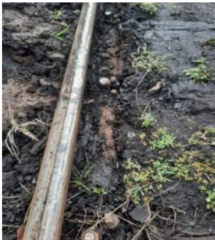
Foto nr.2: urmele lăsate de roțile deraiate
