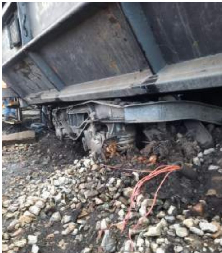
Foto nr.3: vagon în stare deraiată
