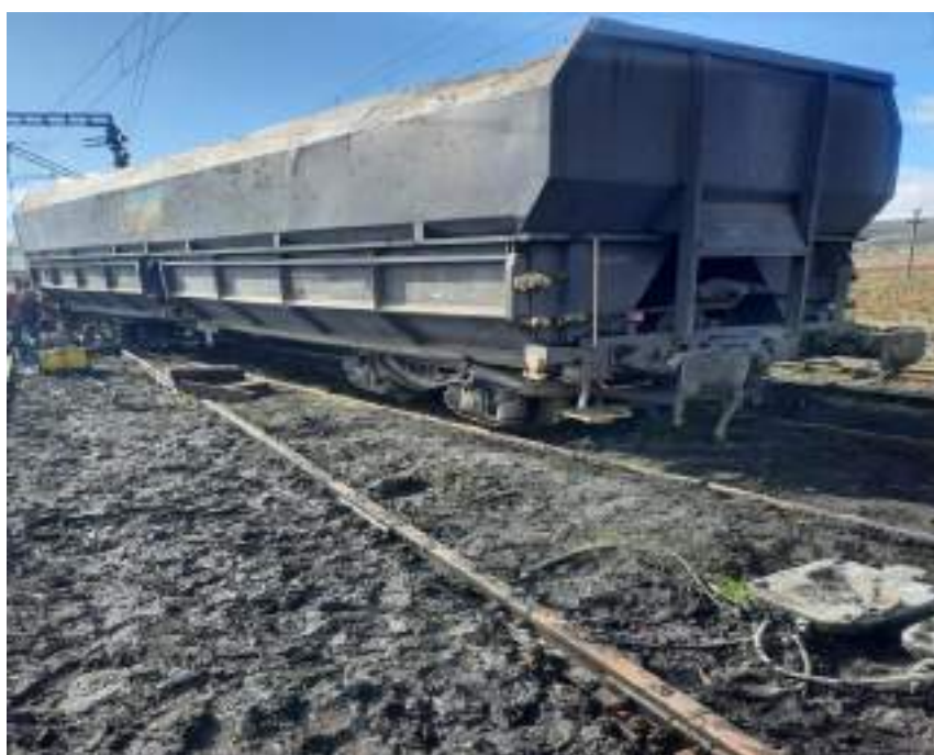
Foto nr.5: Detaliu grad de colmatare a prisme de piatră spartă
