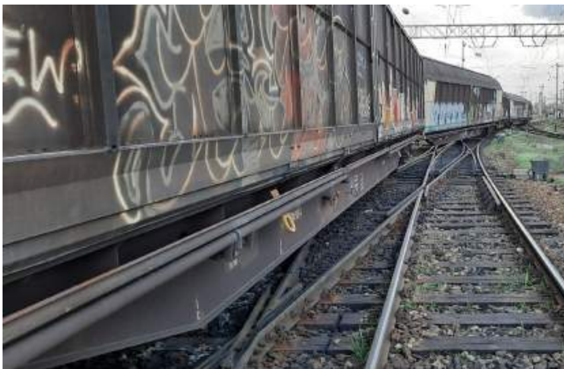
Foto nr.2 – vagoanele deraiate în zona bretelei 15/21-17-25/31-29
