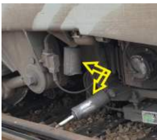
Imaginea nr.2 – amortizor vertical rupt
