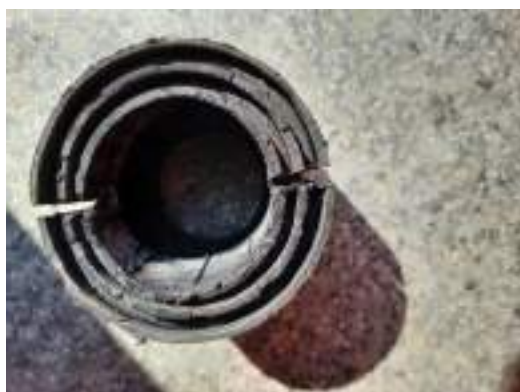
Foto nr.3 Clemele de fixare ale barei de torsiune pe boghiu și elementul de cauciuc
