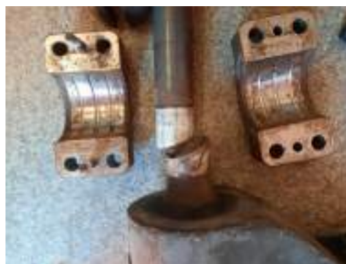
Foto nr.3 Clemele de fixare ale barei de torsiune pe boghiu și elementul de cauciuc
