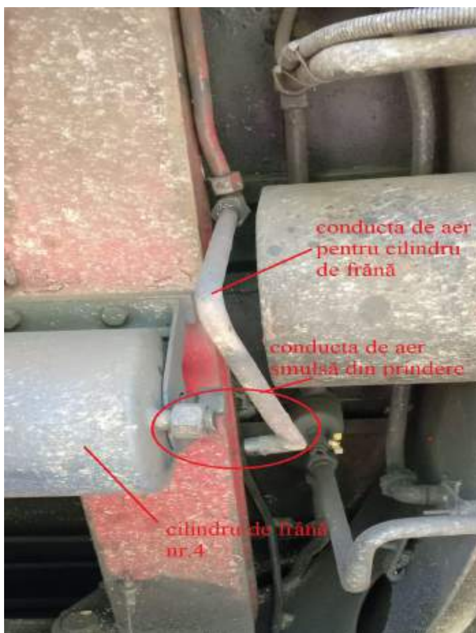
Figura nr.3 – cilindru de frână nr.4 și conducta de alimentare cu aer
