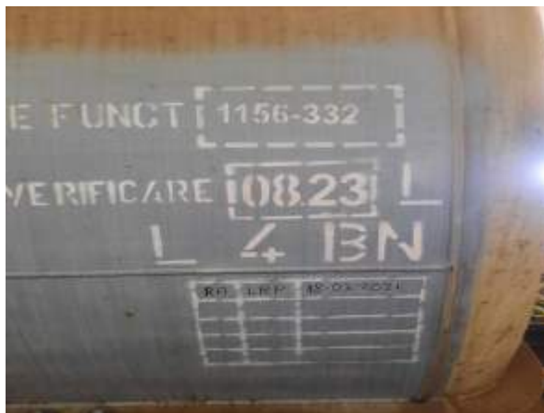
Foto nr. 7 - inscripțiile pe vagon care cu tipul recipientului și data efectuării verificării tehnice periodice
