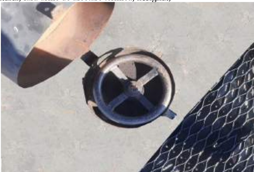
Foto nr. 3 - sistemul de acționare a ventilului central situat la partea superioară a recipientului fără urme de afectare termică
