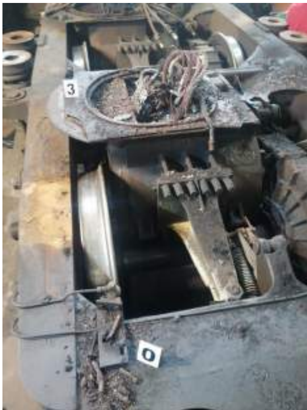
Foto nr.3 – Resturi carbonizate de tub copex și izolație provenite de la cablul bateriei de acumulatori
