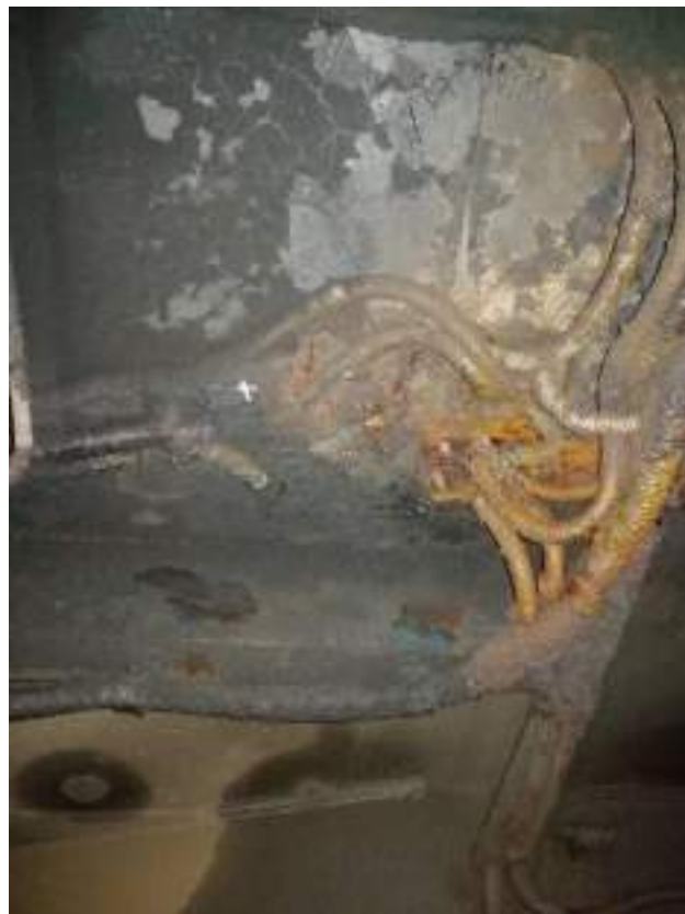
Foto nr.4 – Cablu de la bateria de acumulatori carbonizat și cu urme de arc electric în zona de traversare a podelei locomotivei spre blocul S7
