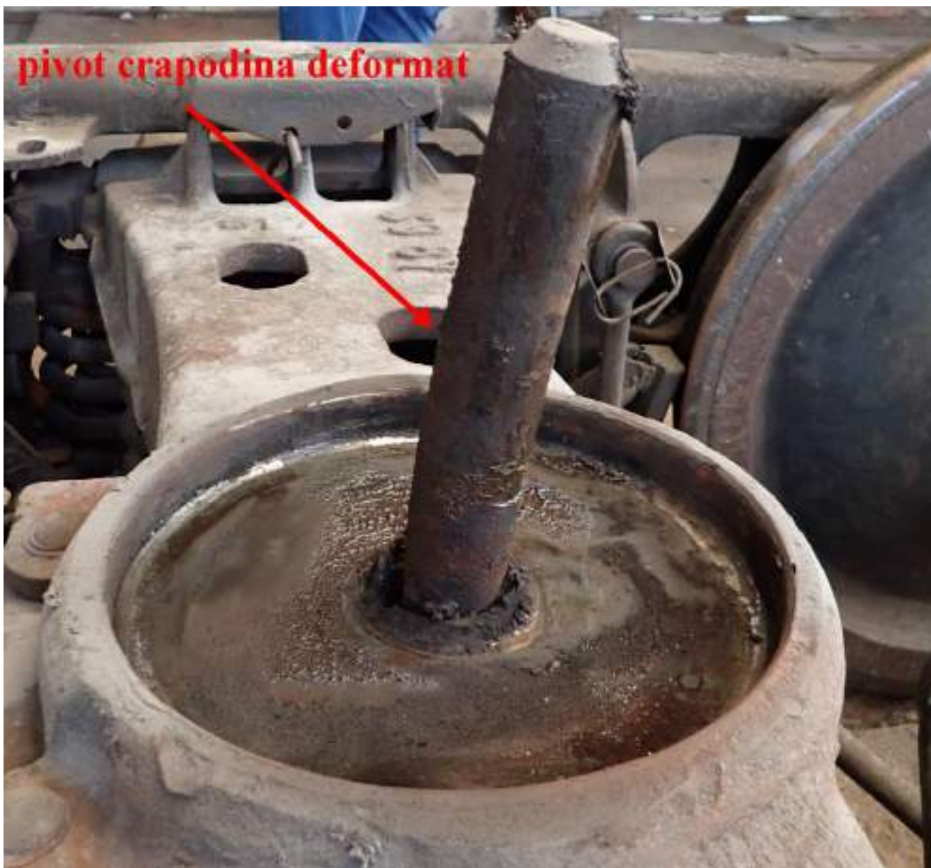
Fig. nr.9, crapodina inferioară cu pivotul deformat
