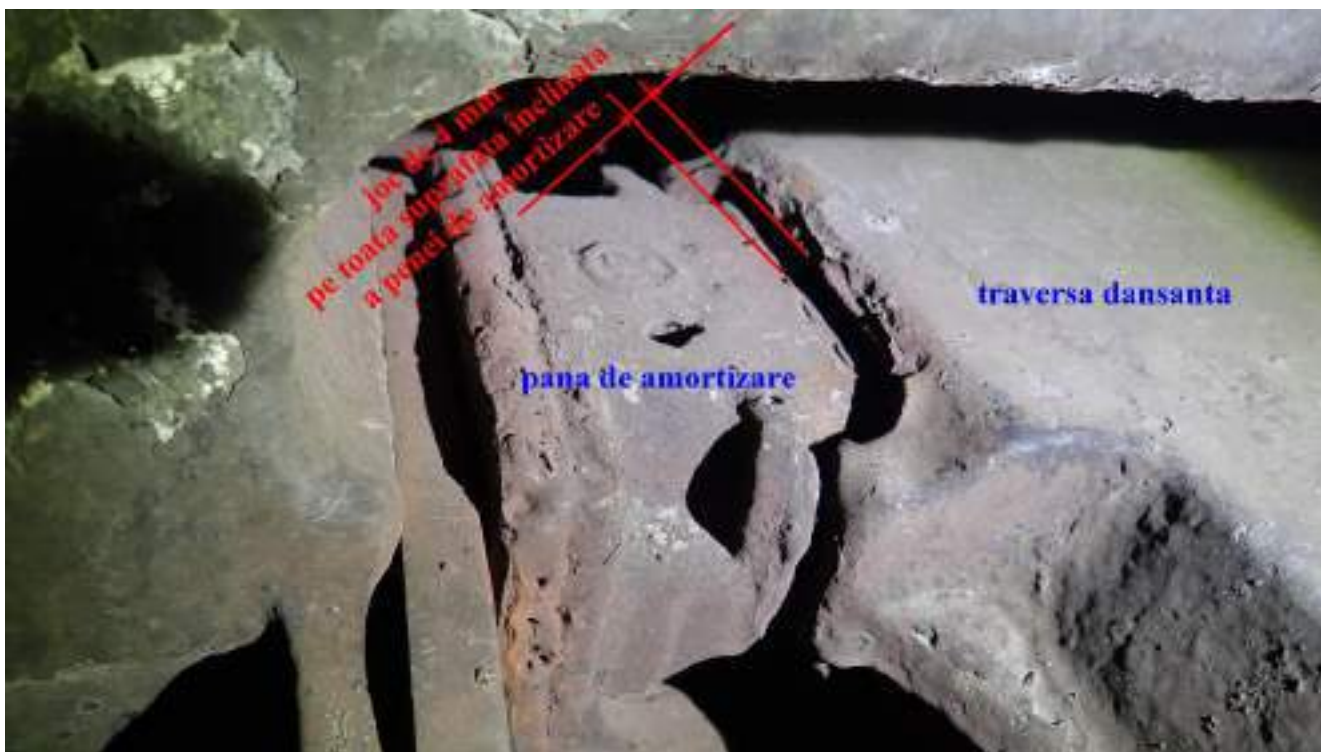
Fig. nr.8, amortizor cu fricțiune constatată cu joc între suprafețele de lucru
