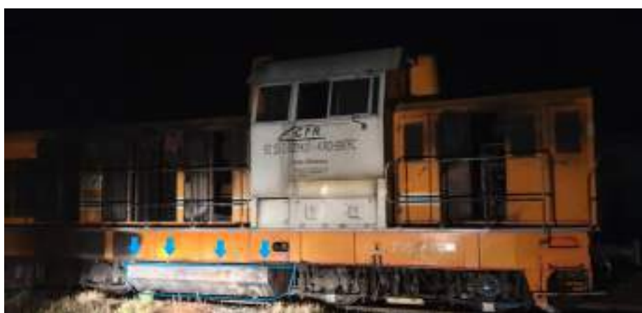
Imaginea nr.3 –amplasamentul rezervorului de motorină cu cele 4 puncte de prindere
