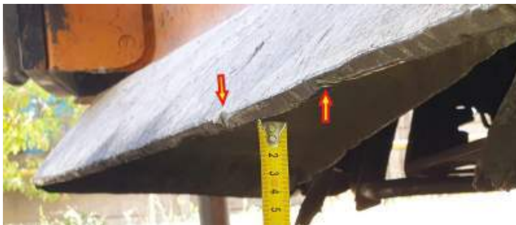
Imaginea nr.14 – apărătorul de animale cu zgârieturi/știrbituri
