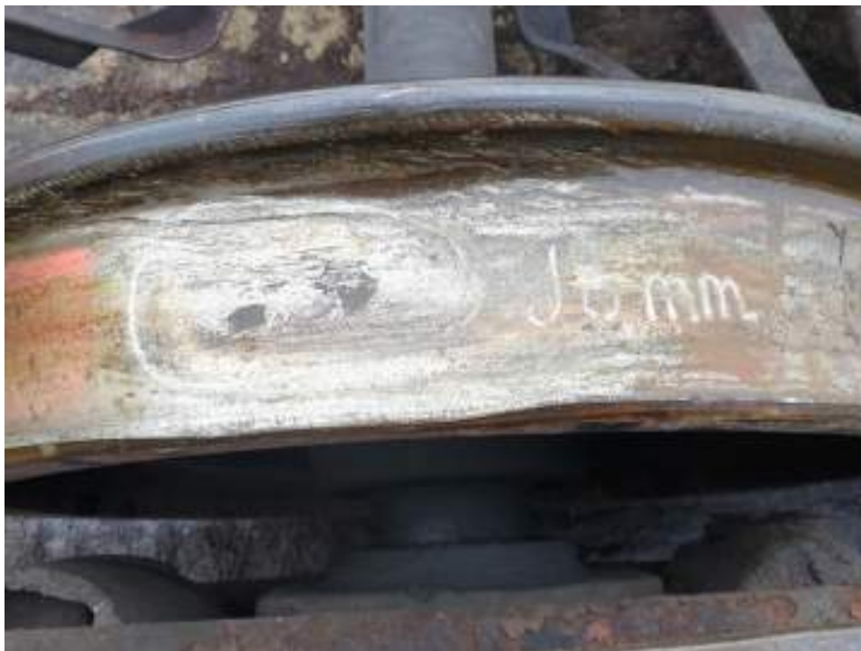
Imaginea nr.9 – Locul plan de 98 mm pe roata nr.6
