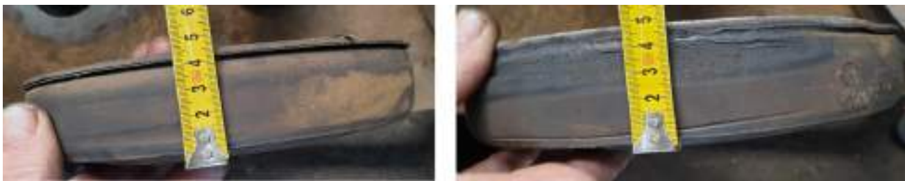
Imaginea nr.7 – arc metalastic deformat cu înălțimea cea mai mică de 44 mm și ce mai mare de 50 mm.
