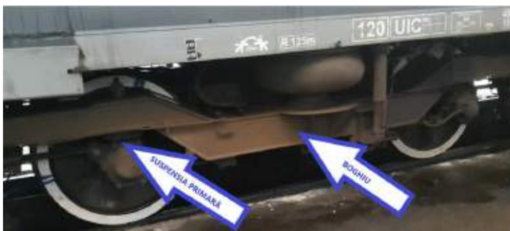
Imaginea nr.5 – localizarea arcurilor metalastic (suspensia primară)
