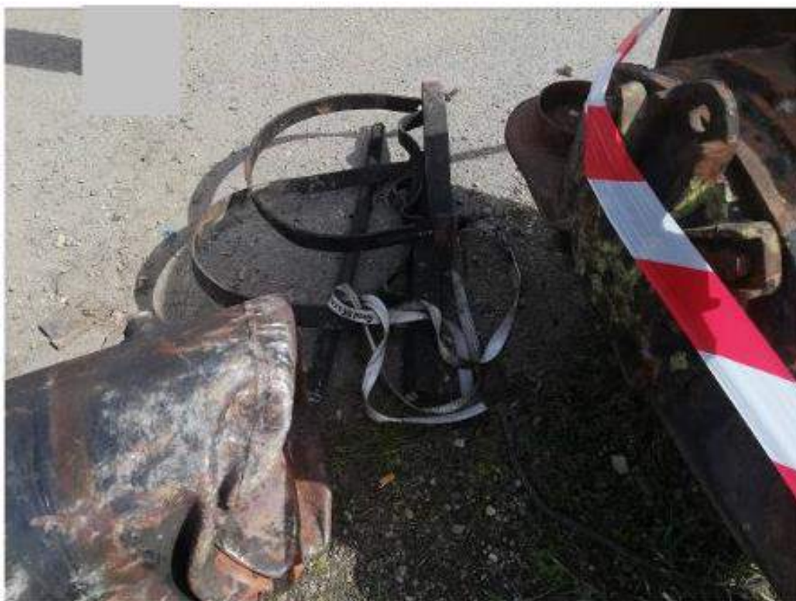
Foto nr.9 - Bara de comutare G-Î ruptă și suporții de susținere a rezervorului de aer
