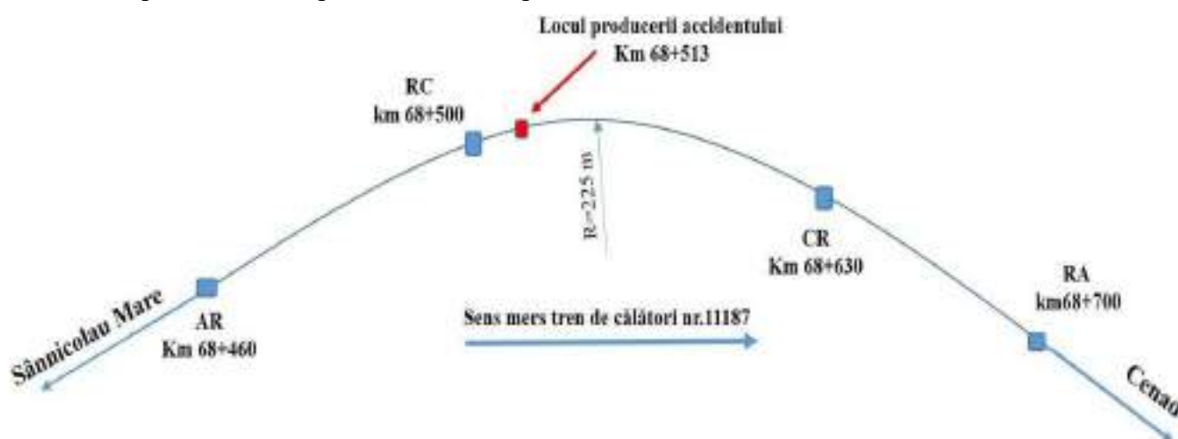
Figura nr.2 - Reprezentarea schematică a curbei pe care s-a produs accidentul feroviar
