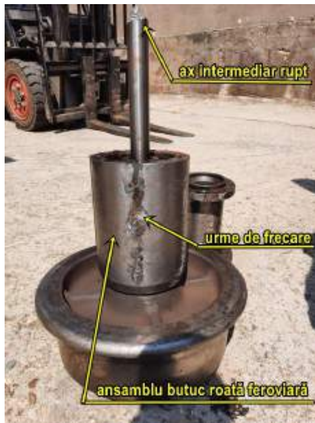
foto nr.4 - ansamblu roată-butuc- ax intermediar planetar
