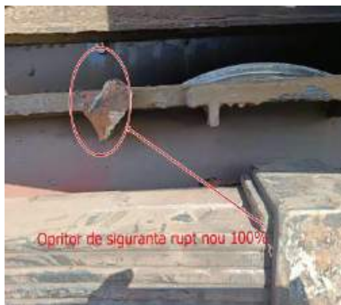
Foto nr.3 – opritor de siguranță ruptură 100% nou
