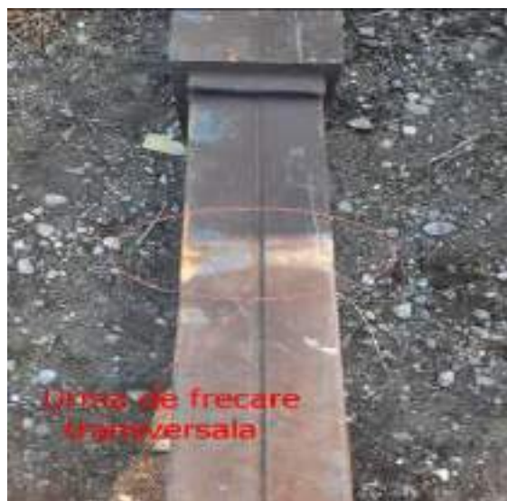
Foto nr.8 Urme de frecare transversală pe foaia principală a arcului
