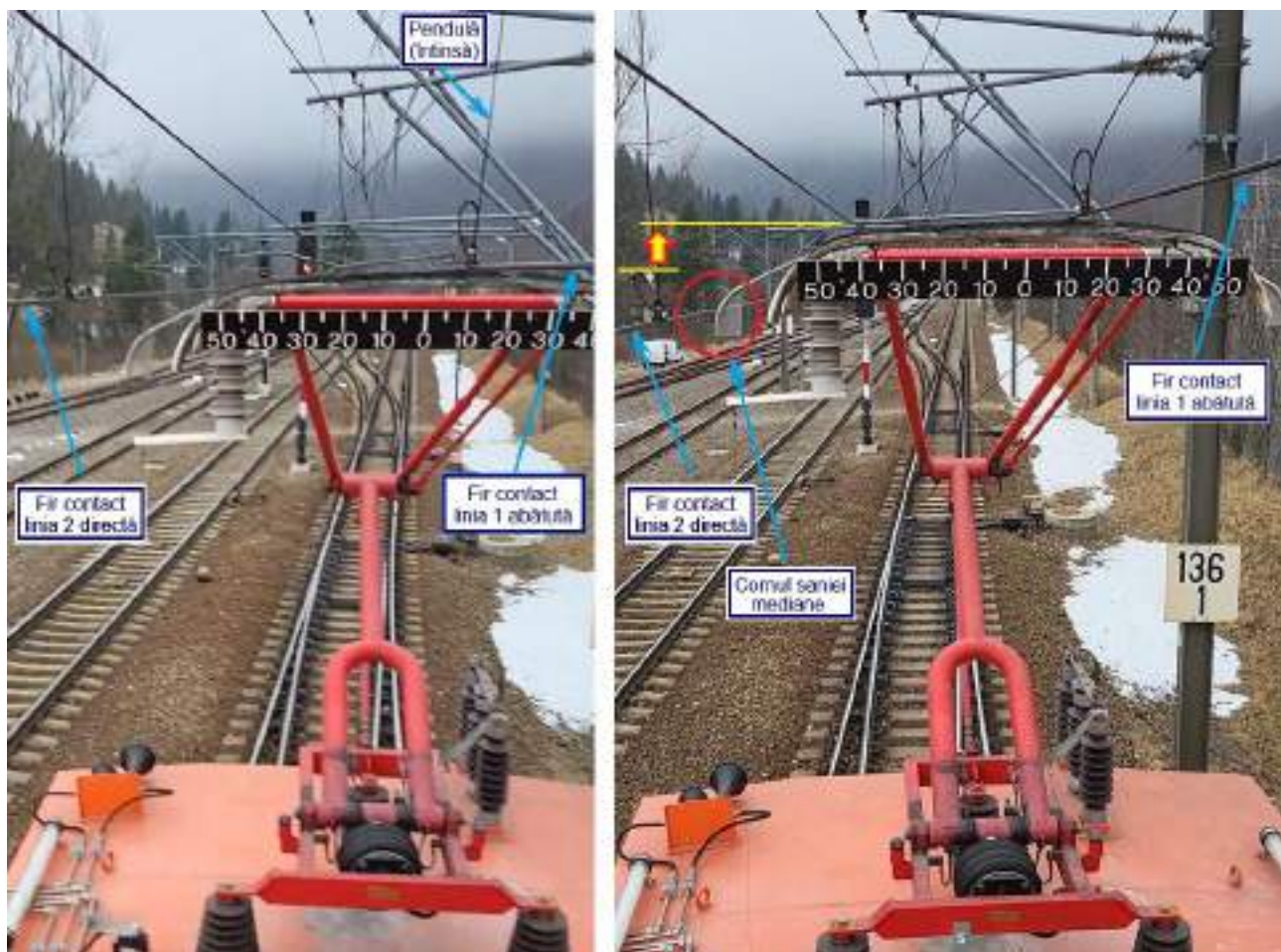
Foto nr.14 și nr.15 – poziția pantografului în zona primei urme de frecare identificată pe firul de contact – simulare prin ridicarea manuală a pantografului drezinei la nivelul corespunzător urmei identificate pe firul de contact de pe linia directă
