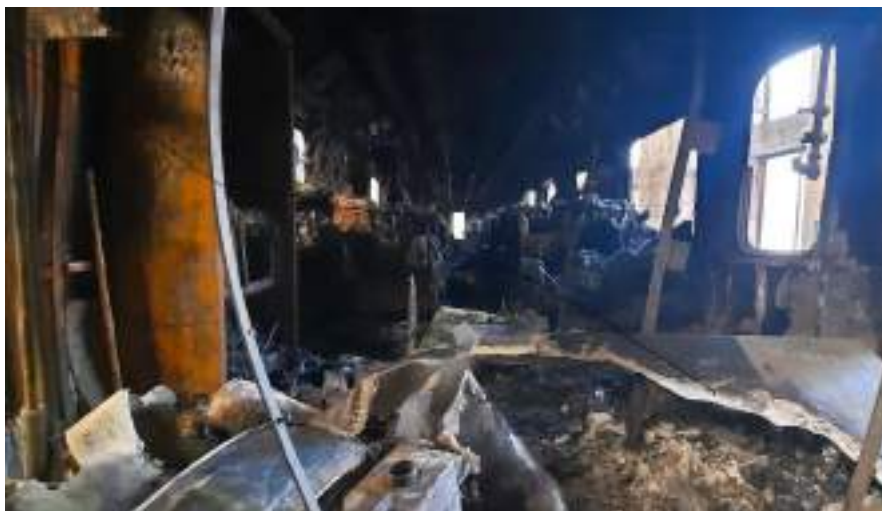
Imaginea nr.9 – interiorul vagonului afectat de incendiu
