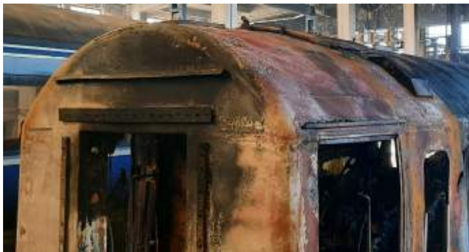
Imaginea nr.6 - acoperiș deformat al cutiei vagonului în zona cabinei de toaletă
