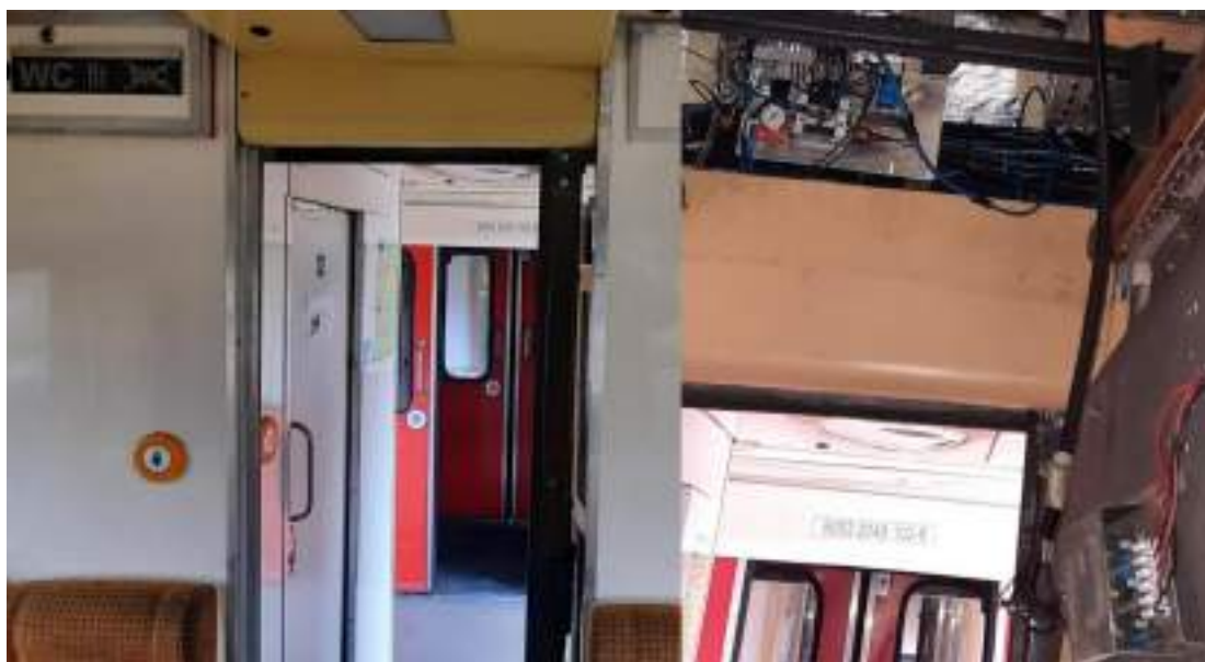
Imaginea nr.15 - Instalația electropneumatică de deschidere a ușii salonului de la un vagon similar
