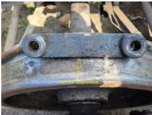
Foto nr.10 levierul atârănător al portsabotului aferent părții din față a roții R2
