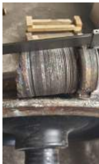
Foto nr.12 - Capăt fus de osie rupt
