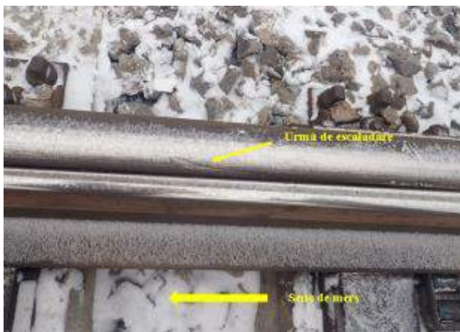
Foto nr. 23 – Urmă de escaladare contraac de către roata nr.7
