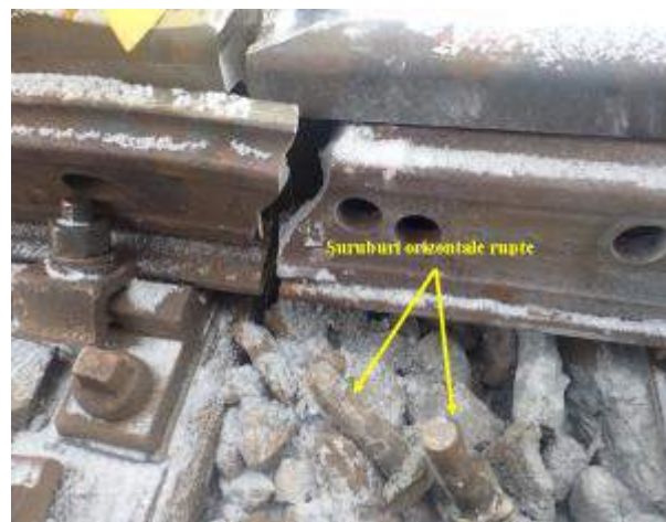
Foto nr.8 – Șuruburi orizontale rupte
