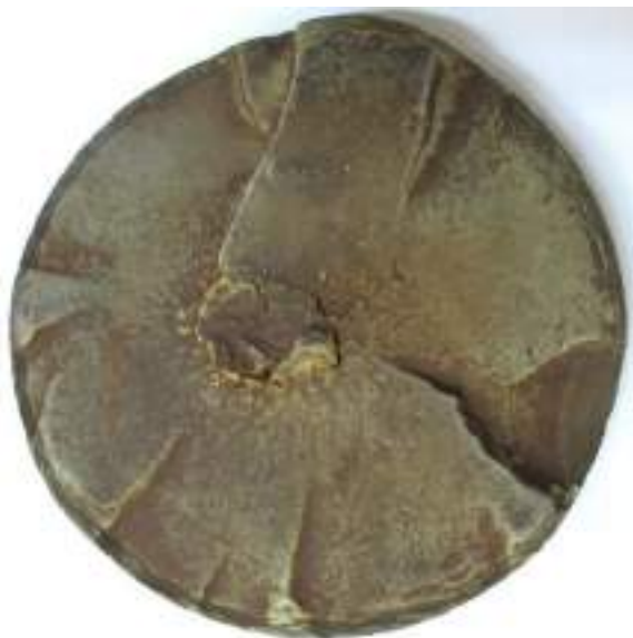
Foto nr. 7– Aspectul uneia din cele două suprafețe de rupere ale fusului rupt de la osia nr.3834212
