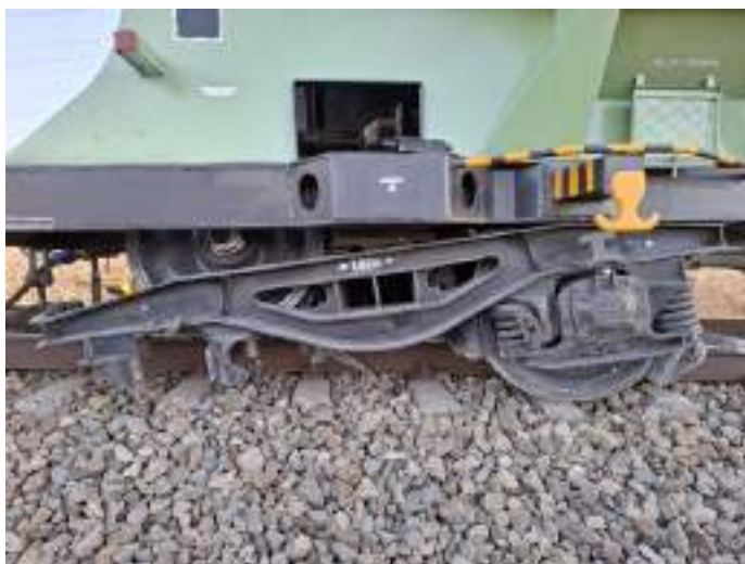
Foto nr.1 - Boghiul deraiat al vagonului nr. 31539333345-7
