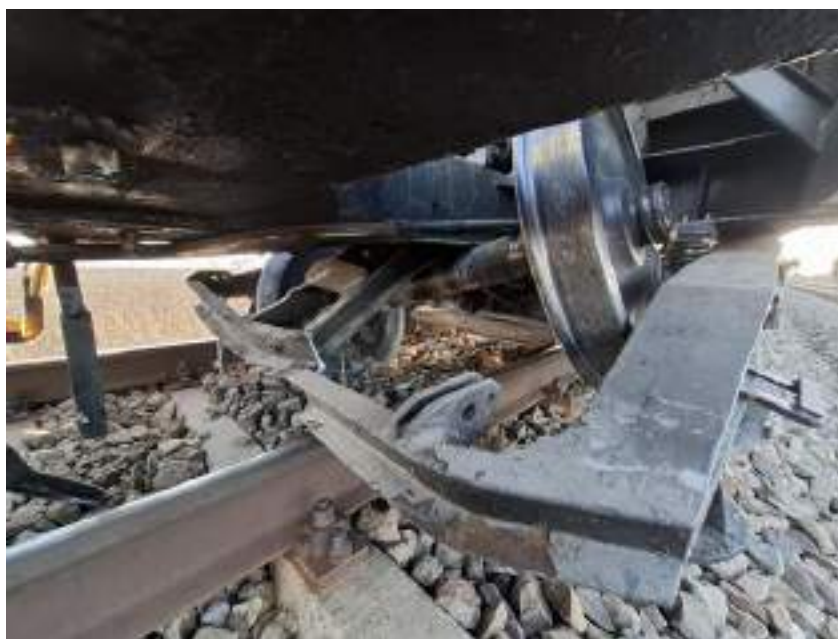
Foto nr.3 – Osia aferentă roților 7-8 după deraiere
