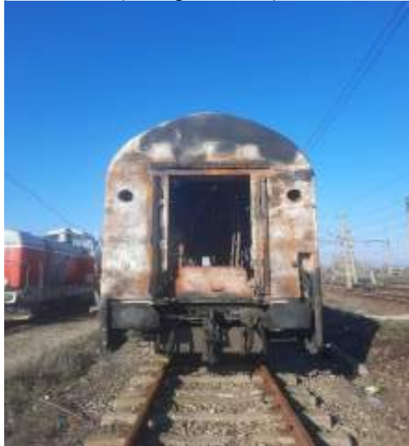
Imaginea nr.4 – Fișa și priza de la capătul de unde a pornit incendiul, corespunzătoare boghiului cu roțile 1-4, lipsă (fără urme de (scurtcircuit)).
