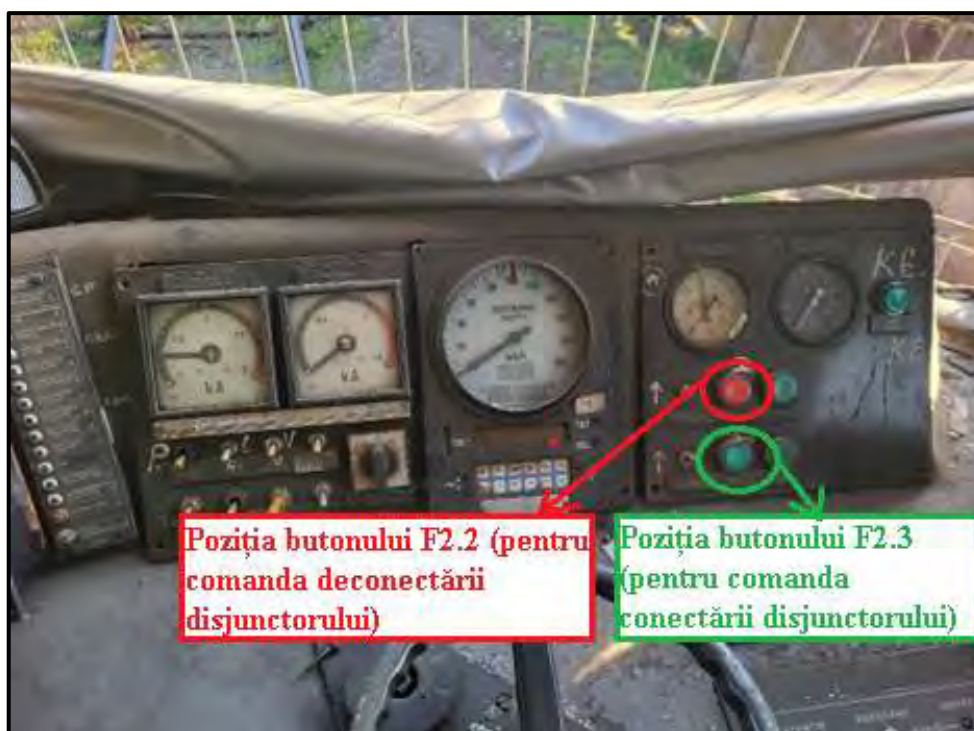
Foto nr.7 – Pupitru de comandă din postul A de conducere cu poziția butoanelor F2.2 și F2.3
