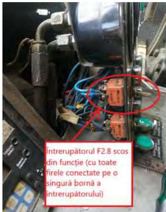
Foto nr.5 - întreprătorul F2.8 postul A era scos din funcție, avea toate firele conectate pe o singură bornă a întreprătorului
