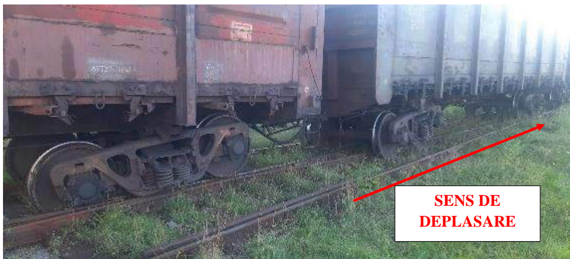
Figura nr.2 - vagoanele deraiate imediat după producerea accidentului feroviar
