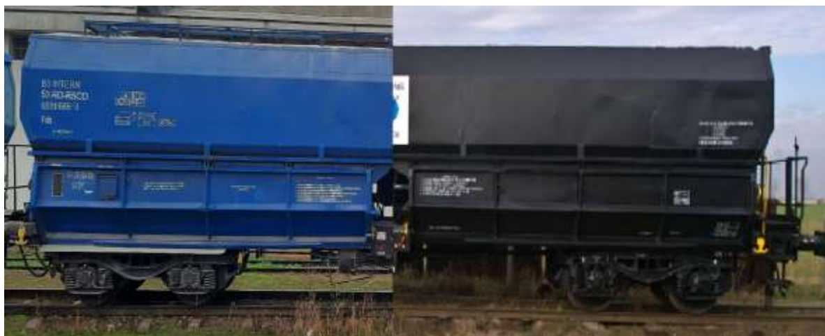
Foto nr. 9 – Vagon seria Fals având prelungirea pantei fixe comparat cu vagon seria Fals fără această prelungire
