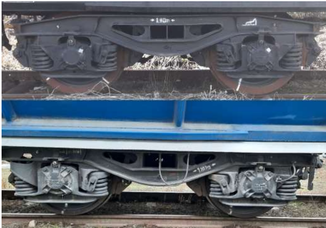
Foto nr.10 – Foto comparativ privind accesul la pietrele de frecare vagon seria Fals (sus) și vagon seria Fals cu prelungire a pantei fixe(jos)
