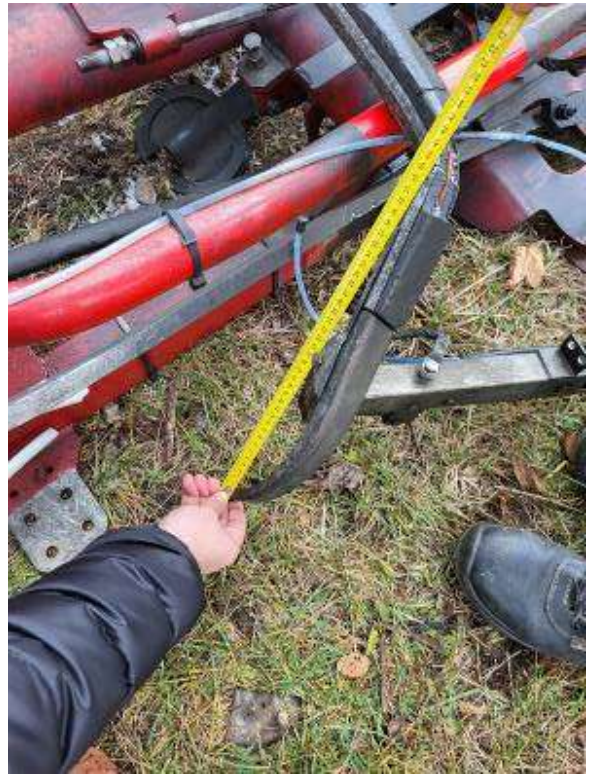
Foto nr.3 și nr.4 – cornul primei portperii a pantografului nr.1 partea stângă
