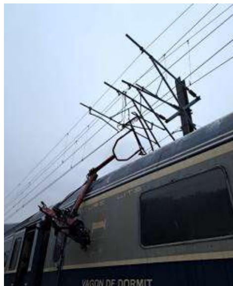
Foto nr.8 și nr.9 – pantograful locomotivei EA 583 după oprirea trenului în stația CFR Azuga - agățat în dreptul celui de-al 3-lea vagon din componere
