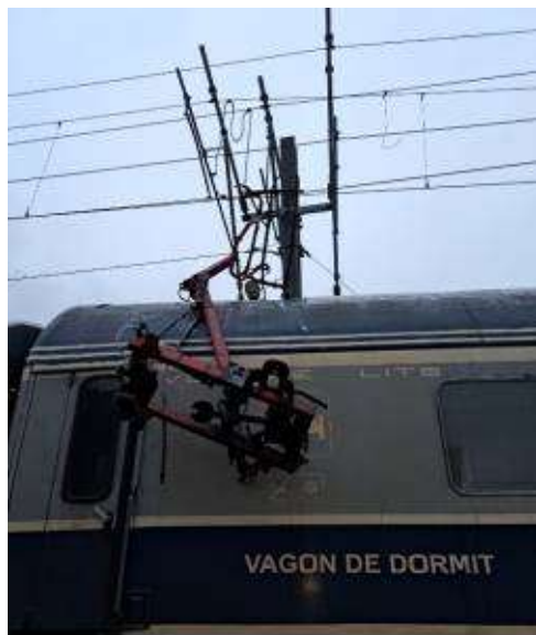
Foto nr.8 și nr.9 – pantograful locomotivei EA 583 după oprirea trenului în stația CFR Azuga - agățat în dreptul celui de-al 3-lea vagon din componere
