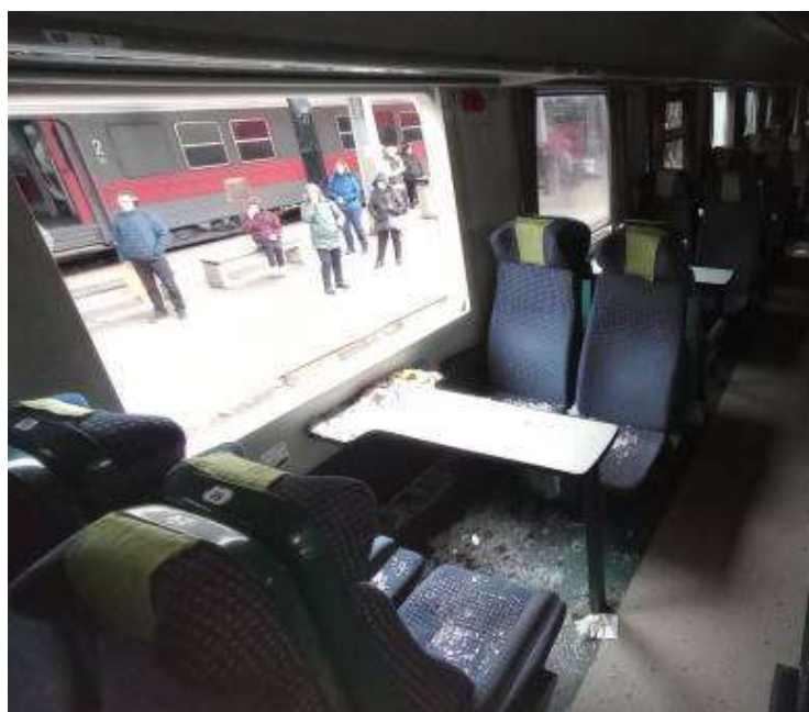
Foto nr.7 – locurile din vagonul nr.61 53 21-76 035-2 afectate de spargerea geamului
