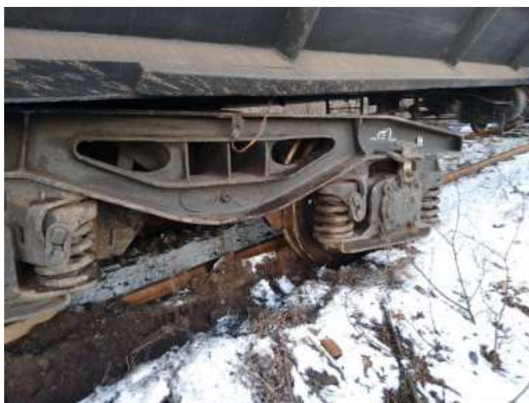
Foto nr.1 : vagonul al 14-lea de la siguranță, nr.81536650824-1, în stare deraiată
