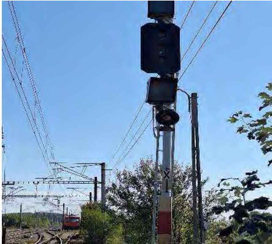
Figura nr.10 -semnal de ieșire X1 în direcția Pasărea fir 1 și stația Voluntari -semnal de parcurs în direcția Pasărea fir 2 și stația Voluntari
