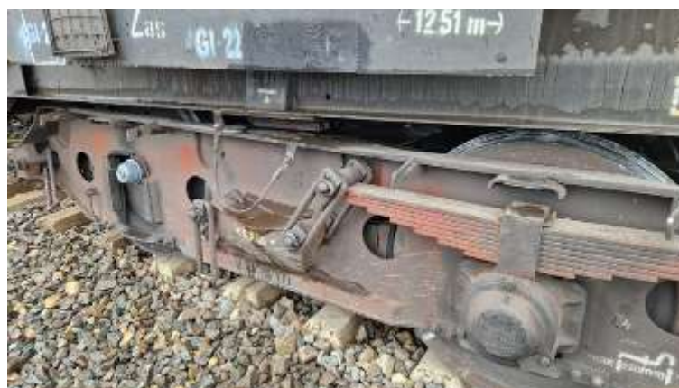
Foto nr.1-boghiul deraiat al vagonului nr.83537963122-8
