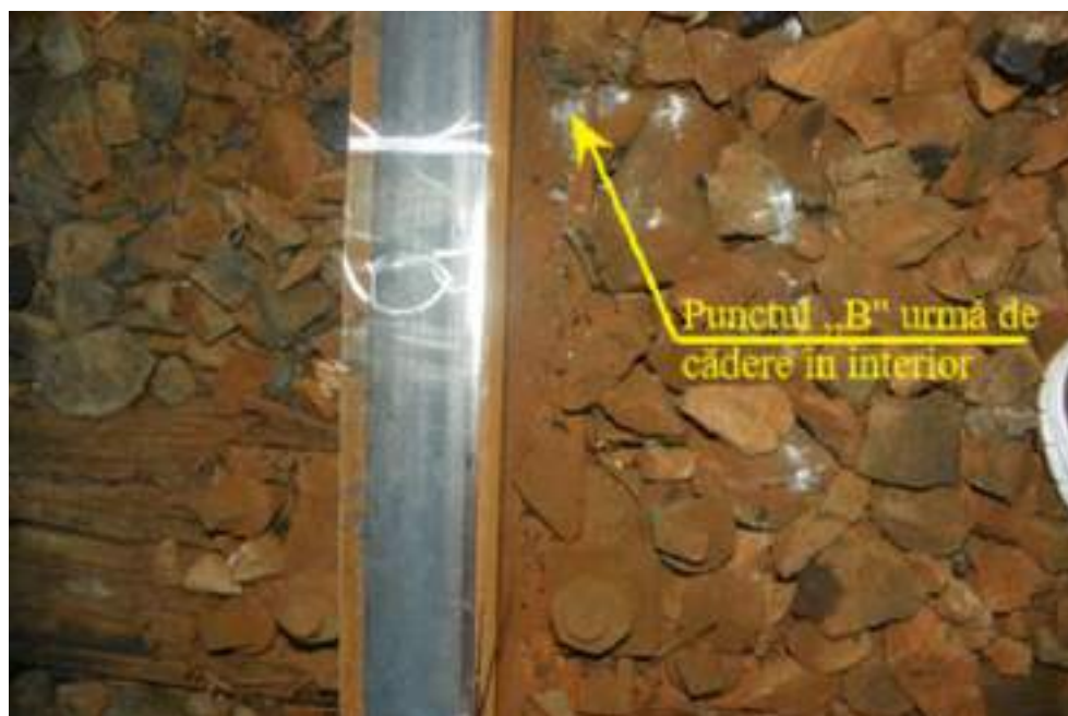
Foto nr.5: Punctul „B” – urmă de cădere în interiorul căii (roata din partea dreaptă stângă a osiei nr.6, în sensul de mers)
