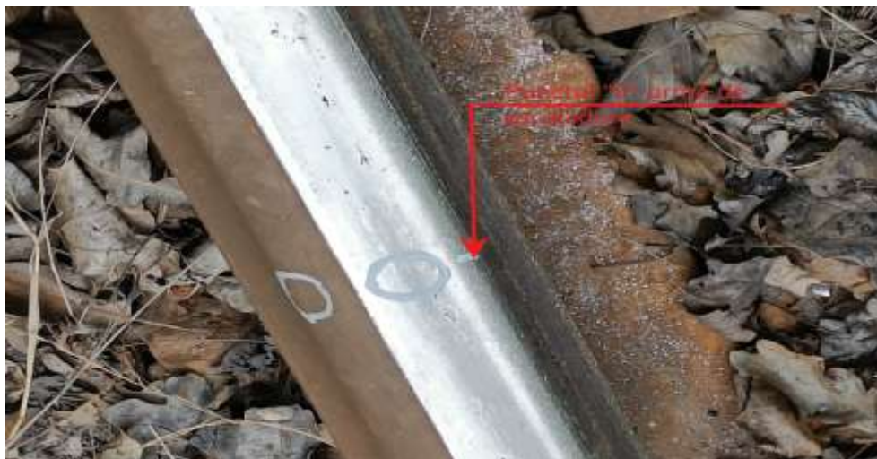
Foto nr.2: Punctul „0” - prima urmă de escaladare la km 18+600 (roata din partea stângă a osiei nr.6)
