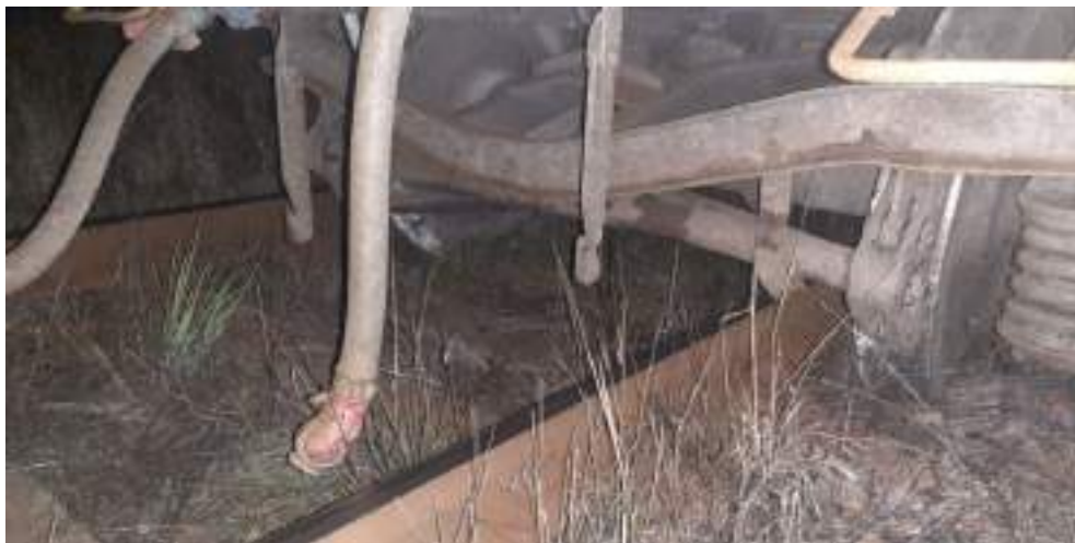
Imagina nr.3 Vagonul deraiat cu roțile 6-8, în interiorul căii și cu roțile 5-7, în exteriorul căii.
